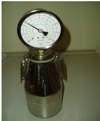
Bild 2: Druckanzeige CM- Feuchte
