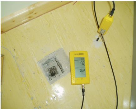
Bild 1: rel. Feuchte untere Dämmung
