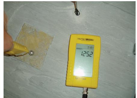
Bild 3: Feuchte im Estrichzement bis 4 cm
